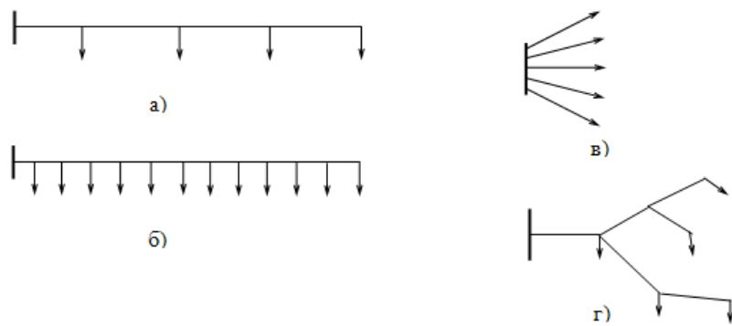
Виды схем: а - магистраль; б - линия с равномерно распределенной нагрузкой; в - радиальная схема; г - радиально-магистральная схема.
