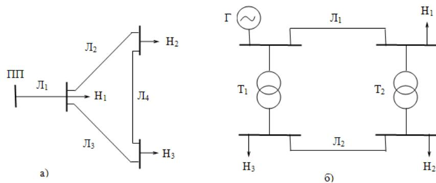
Примеры замкнутых электрических сетей: а- сеть одного напряжения; б- сеть двух напряжений.
